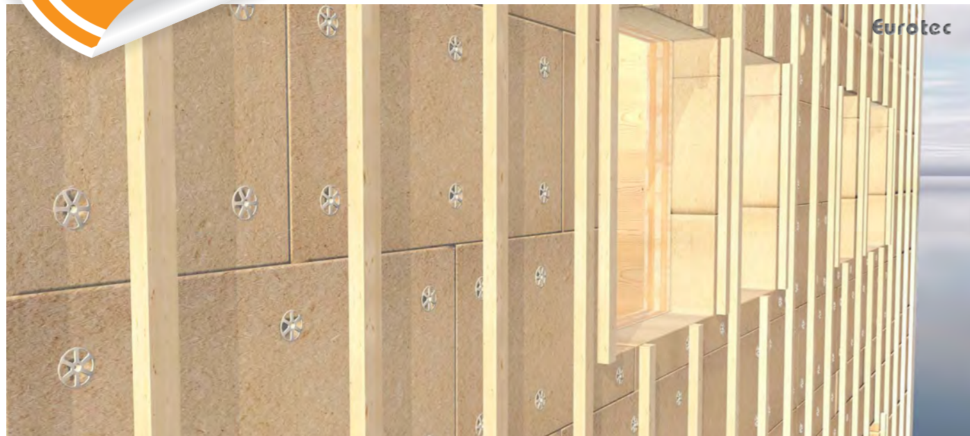
Klimax для крепления изоляционных панелей
